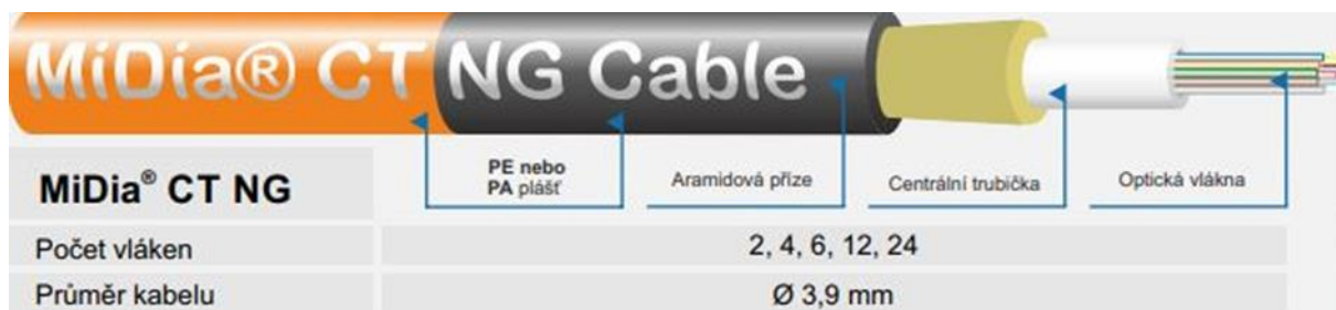
Obrázek 3:51 Struktura zemního optického mikrokabelu
