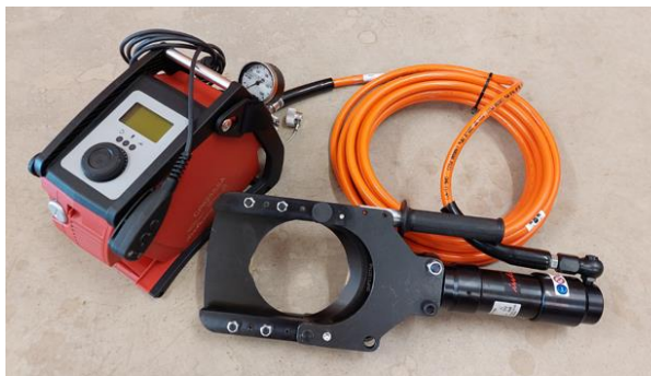
Obrázek 3:72 Střihač Intercable s izolační PPN hadicí
