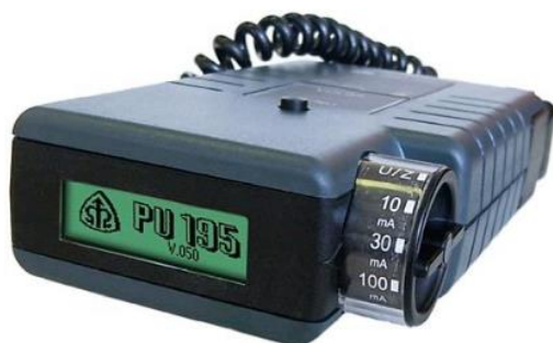
Obrázek 3:95 Starší typ revizního přístroje určený k revizím elektrických instalací PU 195
