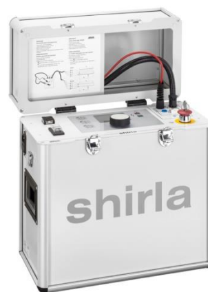
Obrázek 3:66 Shirla – přístroj pro testování pláště kabelů a lokalizaci kabelových poruch
