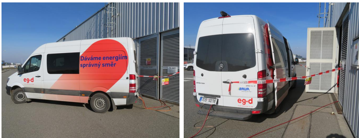
Obrázek 3:63 Kabelový měřicí vůz na podvozku Mercedes Sprinter
