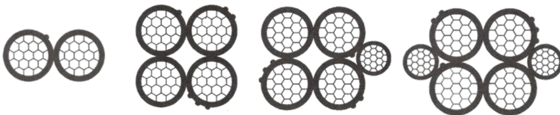
Obrázek 2:30 Konfigurace samonosných vodičů
